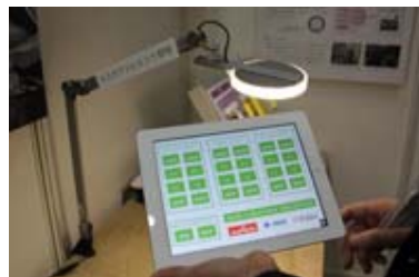
タスク&アンビエント照明と操作パネル
