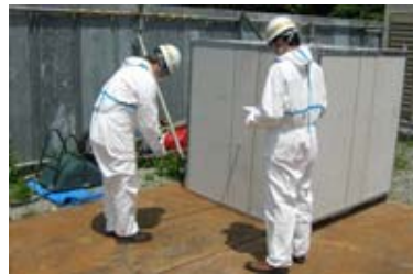
保管容器の遮蔽性能確認実験
