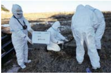
(4) 洗浄後の効果を確認するため事前に放射能濃度を測ります。
