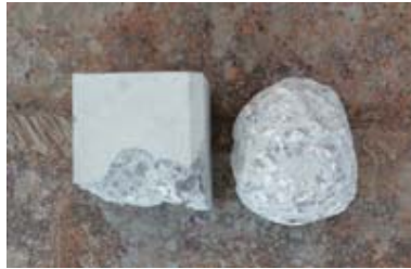
(6) 洗浄前(左)と洗浄後(右)のコンクリート。
