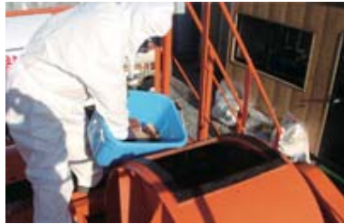
(5) 約10分間の処理でコンクリートや木材は表面が削り取られ、金属は表面のさびが取れます。
