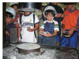
超高強度コンクリートの強度試験の様子
