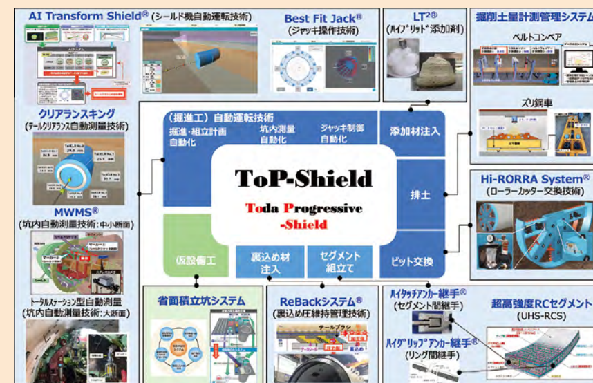
【ToP-Shield】AI Transform Shield®を軸としたシールド工事の施工自動化技術
