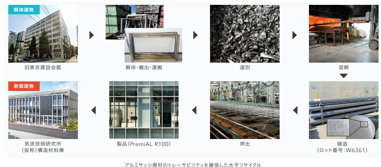
アルミサッシ廃材のトレーサビリティを確保した水平リサイクル
