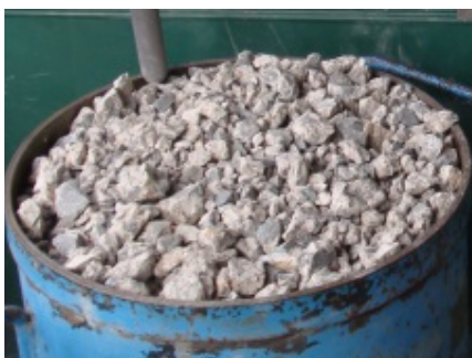
写真1 汚染されたコンクリート（骨材に破碎） 写真2 骨材利用したコンクリートの試験ピース
