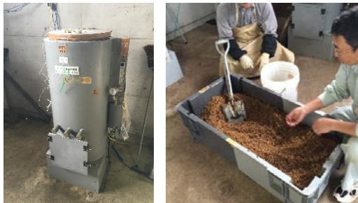
写真-2 80L試験堆肥化装置と堆肥切返し状況
