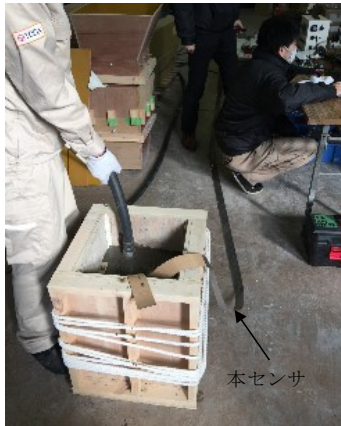
写真-4 締固め検知部に関する室内試験状況
