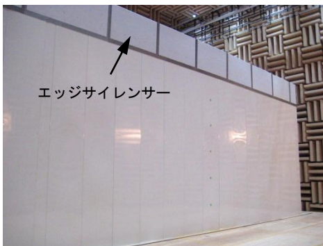
写真-1 騒音低減効果の測定状況
