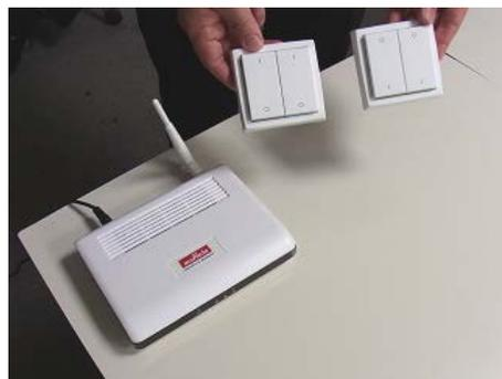
写真-1 照明制御用 Gateway (左) と電池レス無線スイッチ (右)
