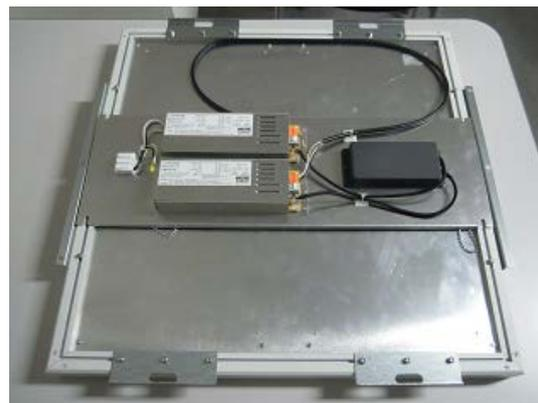
写真-2 LED照明用電源システムと無線通信モジュール
