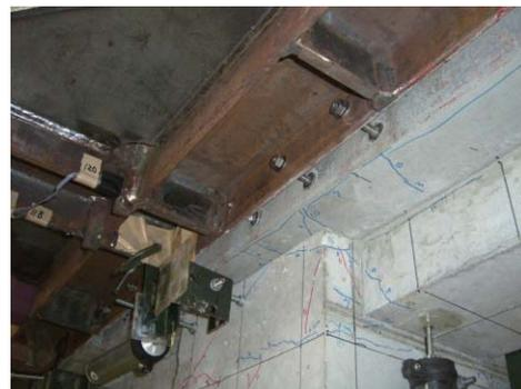
図-12 破壊状況 (WK-17 試験体)
