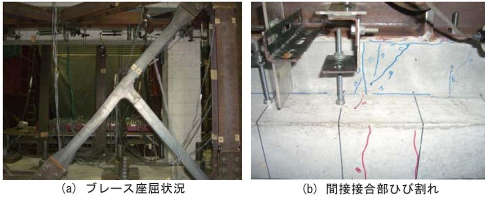
図-10 破壊状況 (WK-16 試験体)
