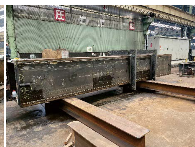
写真 2 1節柱製作状況
