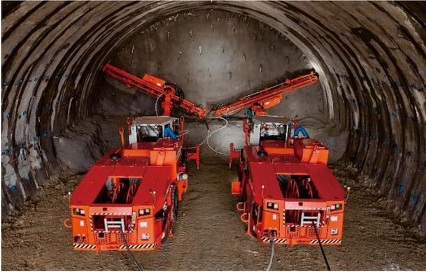
図2 ロックボルト自動打設機
