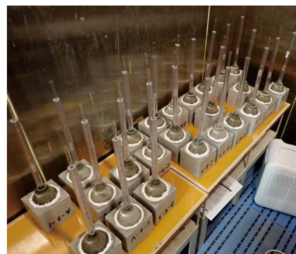
写真 1 透水量試験状況
