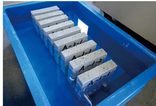
写真 3 透湿度試験状況
