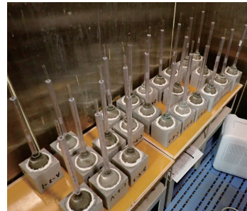
写真1 透水量試験状況
