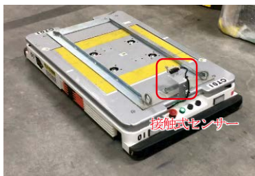
写真1 接触式センサーを搭載したSL-AGV
