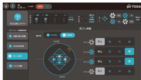
図6 コアコントロールユニット操作画面の一例 (荷振れ制御用画面)
