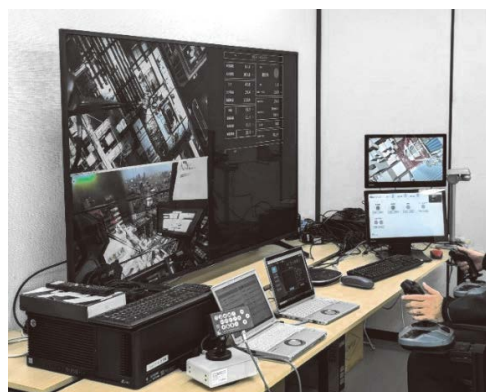
写真3 タワークレーン遠隔操作システム全景
