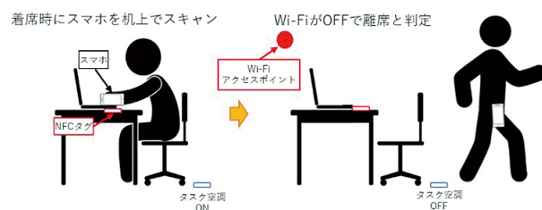
図4 着席／離席検知によるタスク空調制御
