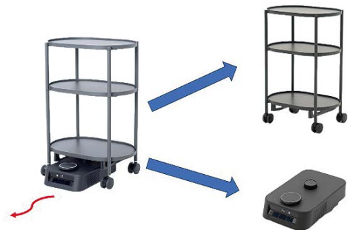
図 15 荷台分離型ロボット「カチャカ」
