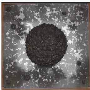
図3 ダイアフラム通過時打ち上がり状況
