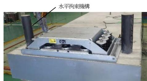
写真 2 機械式制振
