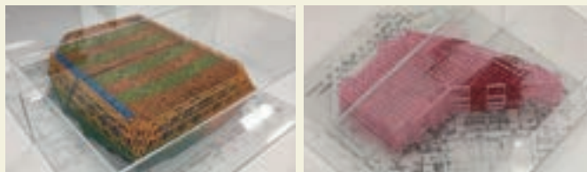
(2) 3Dプリントにて鉄骨工区分担範囲の見える化
