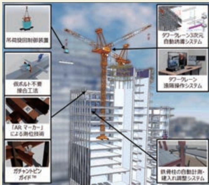
図「鉄骨工事自動化技術」のイメージ
