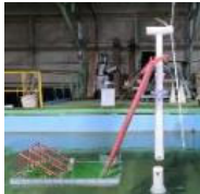
1/100スケール 水槽模型試験
